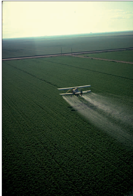
Abb. 31 Pflanzenschutzmittel versprühendes Agrarflugzeug
